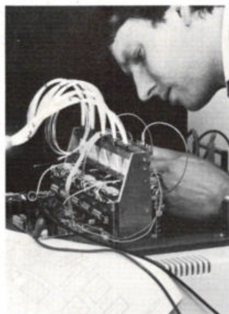
Prototype van een bij Philips-Hamburg ontwikkelde optische printer die een groot aantal lichtbronnen vereist. Deze verkrijgt men met een normale halogeenvlamp waarvan het licht met behulp van bundels glasvezel wordt opgedeeld.
