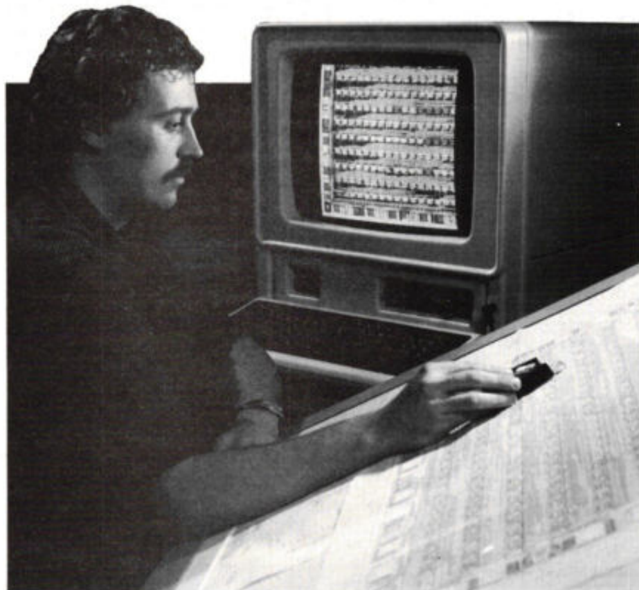
Afb. 1. Controle van de „plot” van een ontwerp voor een digitaal semi custom IC.
