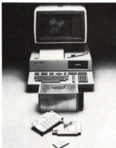
Van component tot eindproduct. Een HP9000 bevat twee „broodtrommels” en in totaal drie kleine ventilatoren die de warmtehuishouding regelen.
